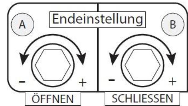
**Einstellschraube B = Endposition Einfahren/Schliessen**
