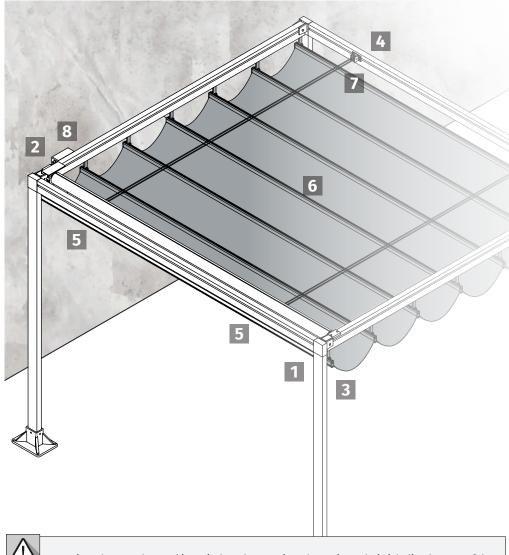
Die Halterung der Markise mit den Platten tritt zuletzt ein, wobei sich die Platten auf der gleichen Seite der Rollen befinden.
