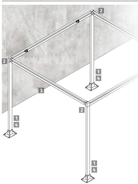
**ATTACH VERTICAL PROFILES** Befestigen Sie die vertikalen Standprofile in den Boden Sockel. Ziehen Sie die Schraube mit Scheibe und Mutter fest an.
