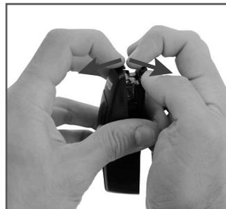
**03** • Öffnen Sie die Lichtschanke, indem Sie die Teile von unten trennen.
